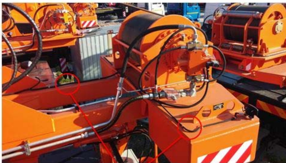
Электроразводка в жгутах
